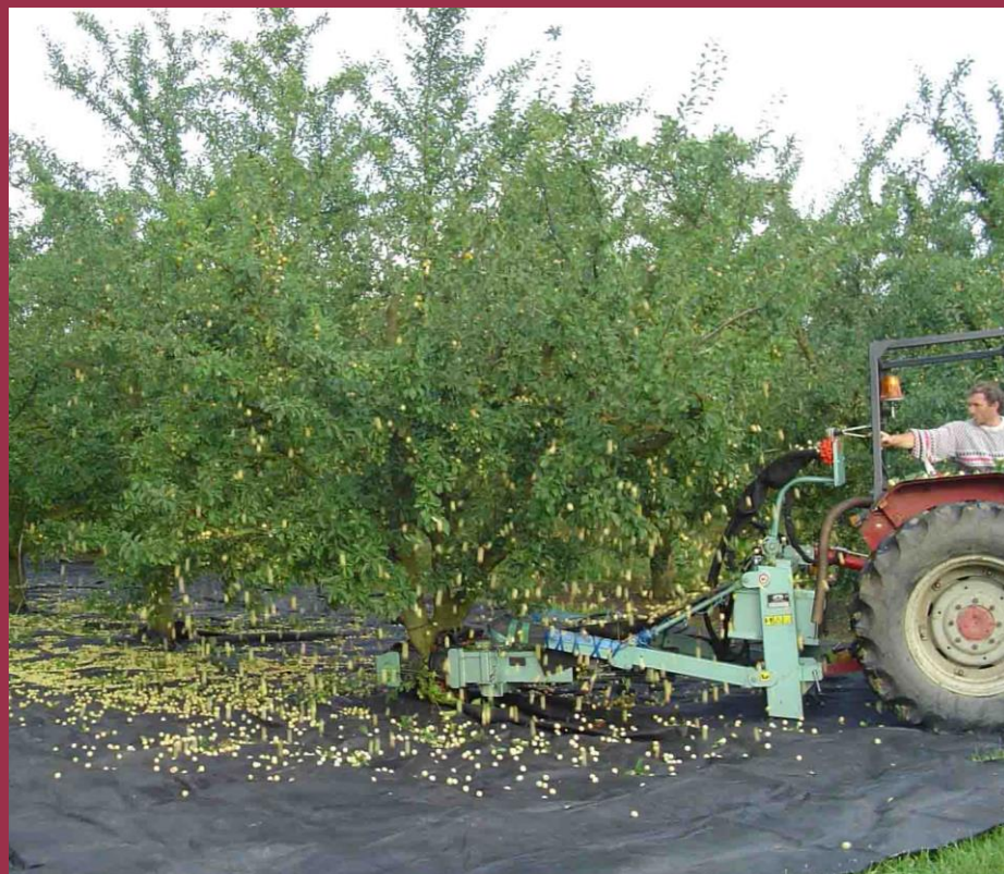
Zapfwellengetriebenes Schüttelgerät im Heckenbau
